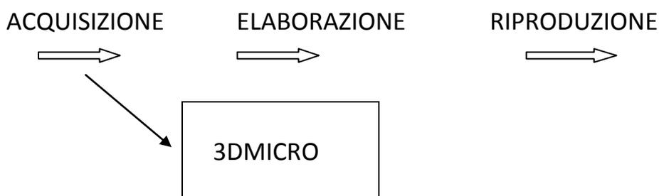
**Acquisizione.** Come i microscopi possono avere diversi obiettivi che permettono differenti ingrandimenti, anche il 3DMicro ha la possibilità di montare diversi gruppi di acquisizione ognuno capace di riprendere una determinata area. I formati di acquisizione partono da 8 x 6 cm fino a 4 x 3 mm.
