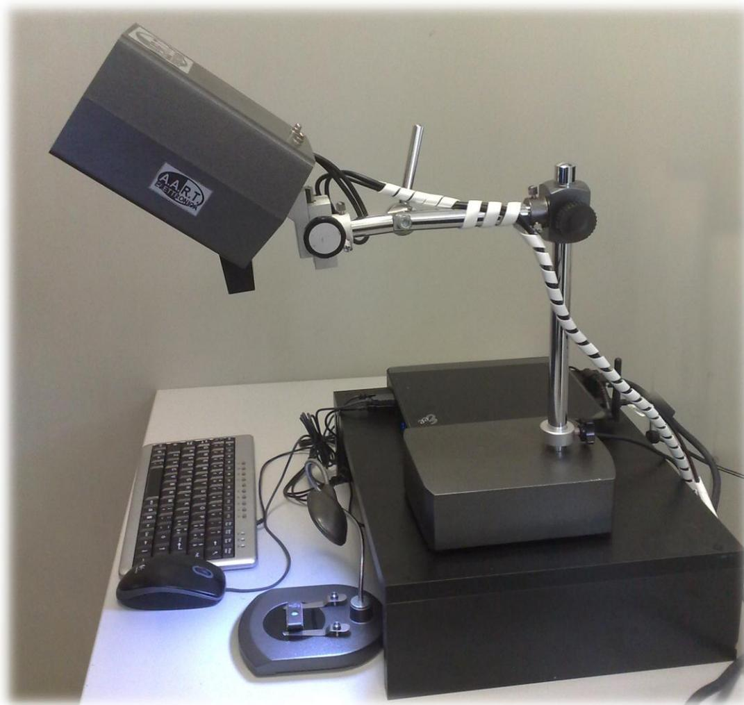
I 3DMICRO per riprese in tempo reale sono forniti in una valigia di metallo. I vari componenti vanno assemblati con una semplice operazione che non necessita di attrezzi, in maniera analoga a un classico microscopio con colonna portante, dove al posto della testa ottica è montato il sistema di acquisizione 3D. Basta inserire i due cavi USB nell'unità centrale di elaborazione, collegare mouse, tastiera, alimentatore e sistema di visualizzazione 3D e il 3DMICRO è pronto per il suo l'utilizzo.
